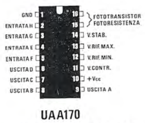
Fig. 2 Connessioni viste da sotto dei due integrati utilizzati in tale progetto.
