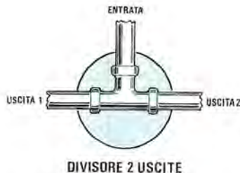
Fig.104 Se avete due colonne di discesa da collegare ad un contatore, vi servirà un Divisore con un ingresso e due uscite di identico diametro.
